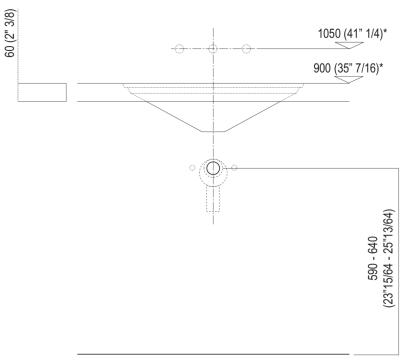
Scarico per sifone ad incasso Drain for concealed waste trap
