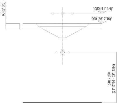
Scarico per sifone a bottiglia Drain for bottle trap
