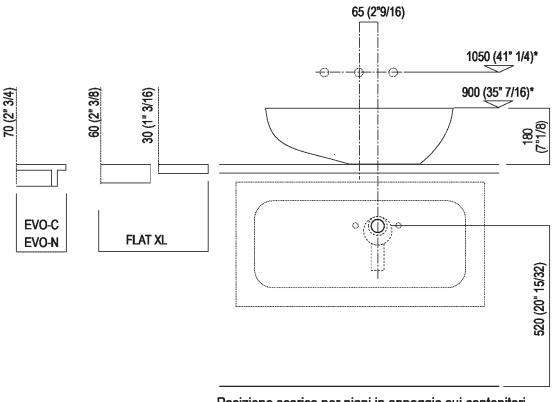
Posizione scarico per piani in appoggio sui contenitori Drain position for top on storage units
