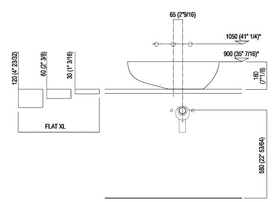
Scarico per sifone ad incasso Drain for concealed waste trap
