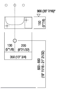
Scarico per sifone a bottiglia Drain for bottle trap
