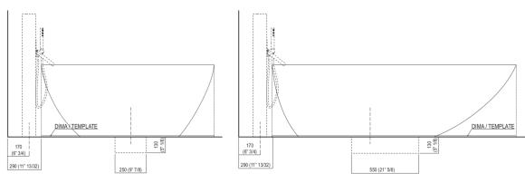
Per un corretto posizionamento del pozzetto e della rubinetteria è necessario utilizzare la dima in cartone con sagoma uguale al profilo superiore della vasca.
