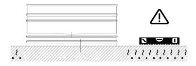
La vasca deve essere installata su un pavimento perfettamente piano. The bathtub must be positioned on a flat floor surface.
