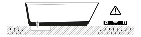
La vasca deve essere installata su un pavimento perfettamente piano. The bathtub must be positioned on a flat floor surface.
