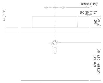
Scarico per sifone ad incasso Drain for concealed waste trap
