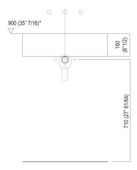
Scarico per sifone ad incasso e piletta con canotto fisso Drain for concealed waste trap with not adjustable pipe
