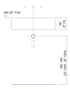
Scarico per sifone ad incasso Drain for concealed waste trap
