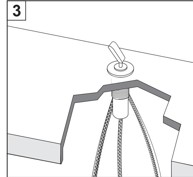
Collegare il flessibile M alla bocca e gli altri due alla rete idrica. Connect the flexible hose M to the spout and the other two to the water mains.
