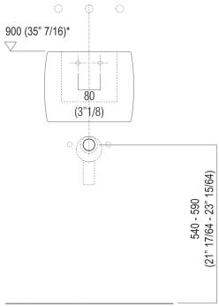
Scarico per sifone ad incasso Drain for concealed waste trap
